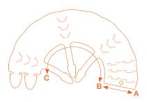
Système d'attache rapide et sécurisé par un double passage des languettes.
